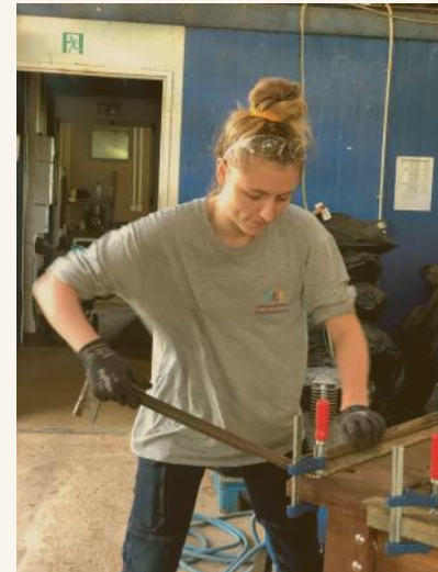
Alycée de l'Association de Java's qui crée les tiges de métal pour les fondations.
